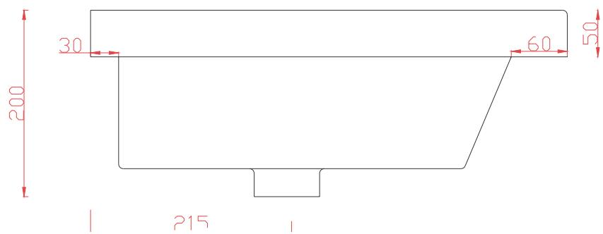
N.B. Le misure indicate possono subire una variazione dell'0,6% circa, dovuta ad usura stampi e a variazioni delle caratteristiche tecniche relative alle materie prime che compongono l'impasto .
